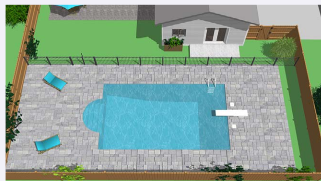
Exemple d'utilisation d'une clôture de terrain comme partie d'une enceinte de la piscine. Dans ce cas-ci, un seul nouveau pan de clôture a été ajouté pour sécuriser l'accès à la piscine à partir de la résidence et de la cour avant.
