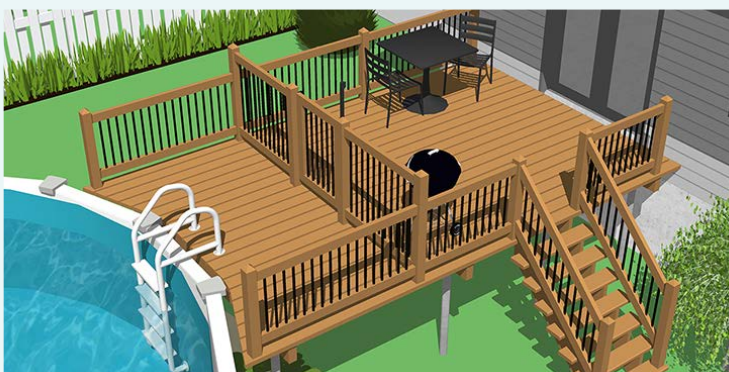
Exemple de terrasse rattachant la piscine à la résidence. La clôture empêchant l'accès à la piscine doit toujours avoir au moins 1,2 m de hauteur.
